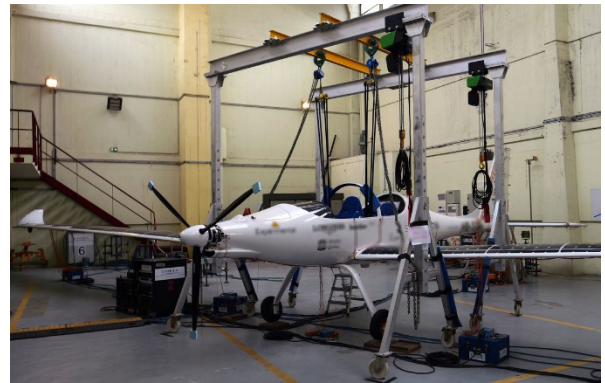
Essais de vibrations au sol d'un planeur
