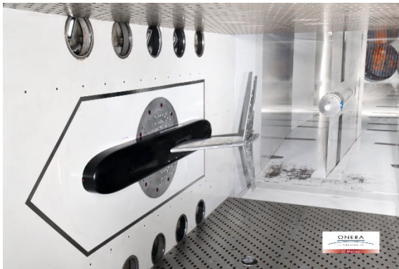
Maquette de flottement dans la soufflerie S2MA
